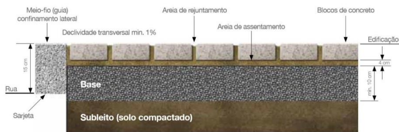
Figura 06- Estrutura das camadas da pavimentação intertravada.
