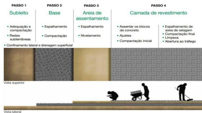
Figura 05- Etapas da execução da pavimentação intertravada.
